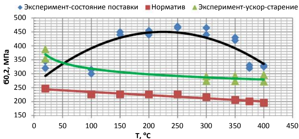
Рис. 2. Зависимость условного предела текучести \sigma_{0,2} от температуры испытания для образцов в состоянии поставки и после ускоренного старения
