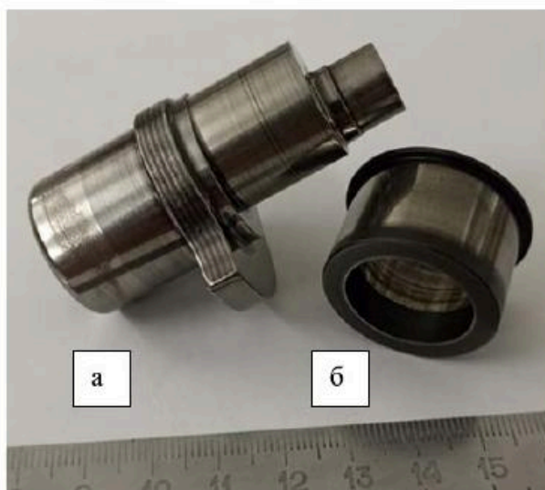
Рис. 1. Внешний вид деталей: кулачковый вал (а) и втулка — подшипник скольжения (б)
