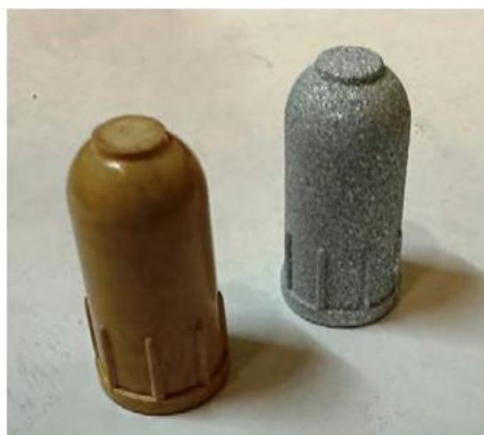
Рис. 2. Колпачок датчика без и с нанесенным алюминиевым покрытием
