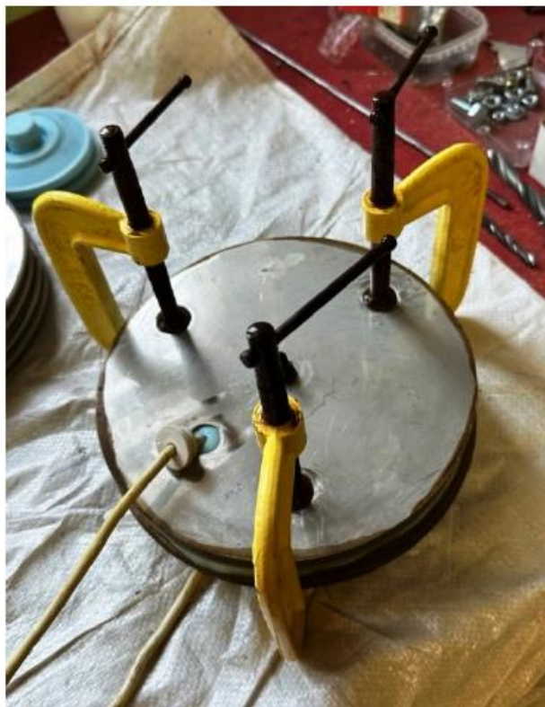
Рис. 5. Оснастка для МДО крупногабаритных шкивов
