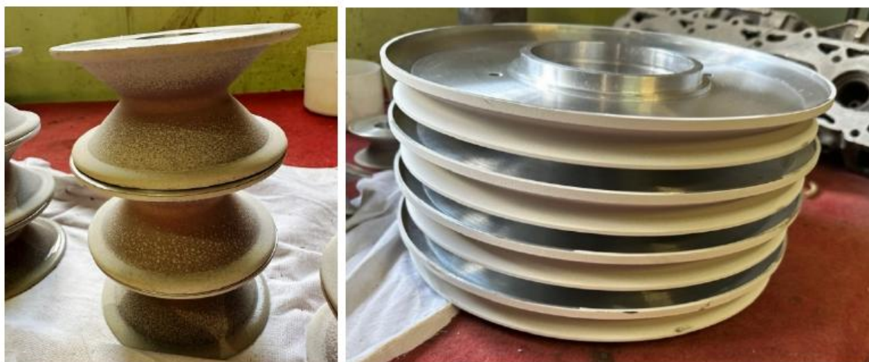
Рис. 4. Примеры шкивов, упрочненных микродуговым оксидированием
