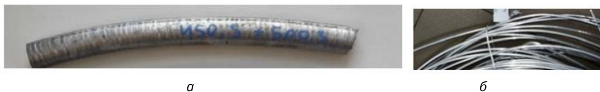
Рис. 1. Фрагменты ЭМК заготовки (а) и полученного из нее прессованного прутка (б)
