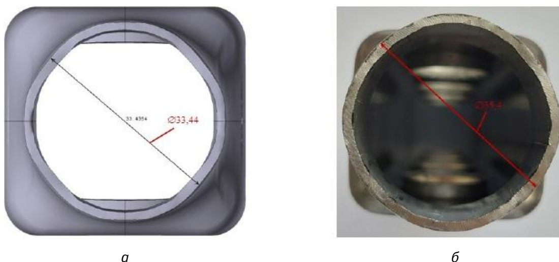
Рис. 3. Размеры диаметра горловины коллектора после 4-го перехода: а — результат моделирования; б — фотография с производства
