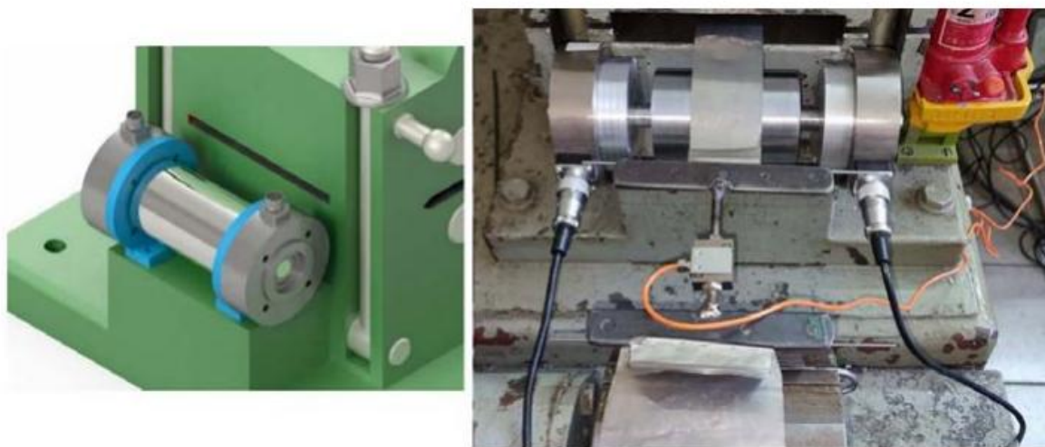
Рис. 2. 3D-модель и внешний вид натяжного ролика с силоизмерительными датчиками
