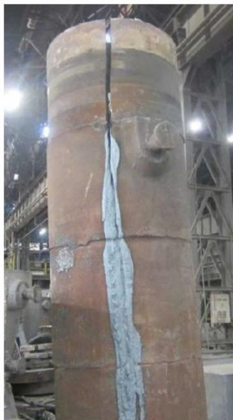
Рис. 2. Изложница, разрушенная в результате развития трещины первого рода
