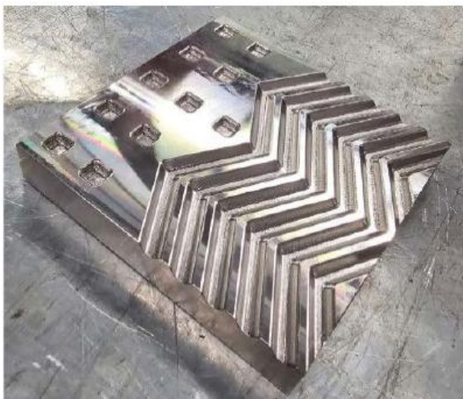
Рис. 3. Матрица для штамповки элементов плоских теплообменников
