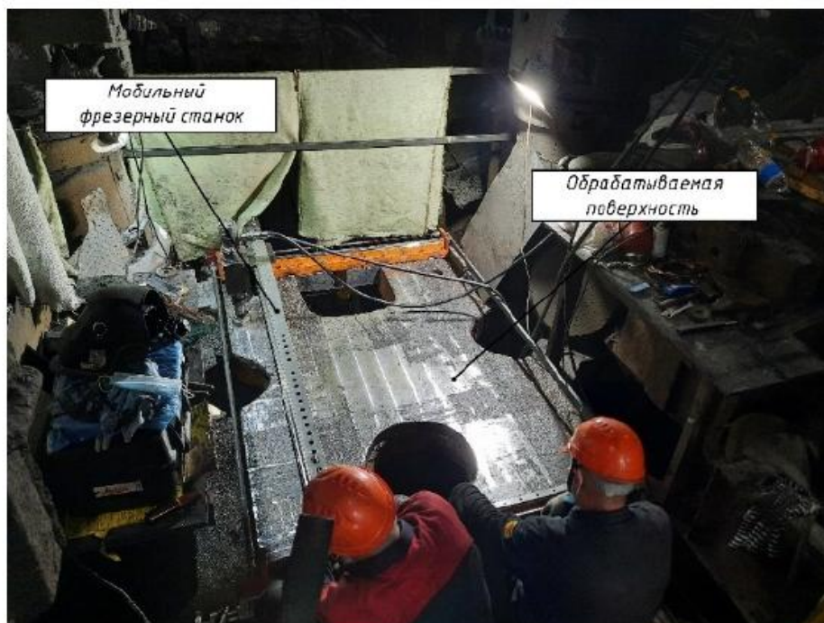
Рис. 10. Процесс механической обработки основания прессы мобильным фрезерным станком
