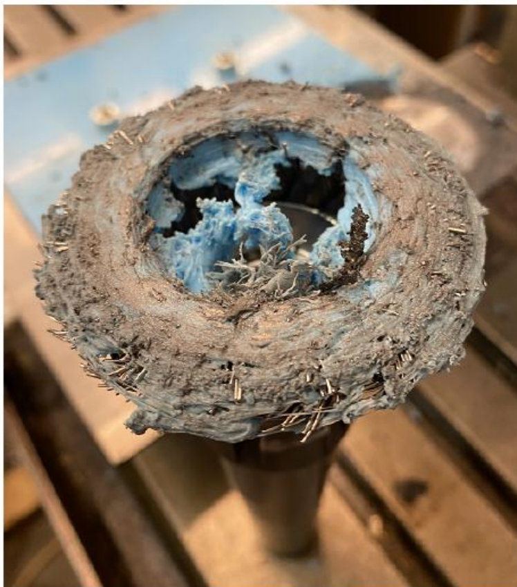
Рис. 9. Заполнение торцевой щетки расплавленным полипропиленом
