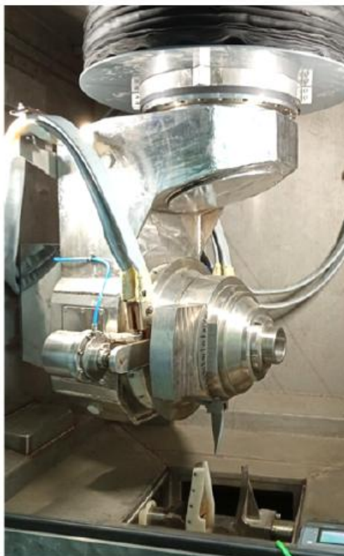
Рис. 3. Фото рабочей камеры станка ЭХО-МК с открытой дверью
