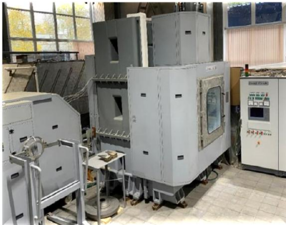
Рис. 1. Фото электрохимического комплекса ЭХК-МК для ЭХО лопаток моноколес
