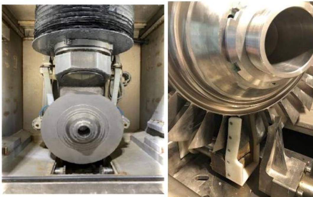
Рис. 8. Фото заготовки моноколеса, закрепленной на планшайбе станка ЭХО-МК перед черновой ЭХО (слева) и после чистовой ЭХО (справа)
