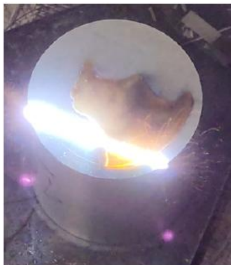
Рис. 2. Выжигание алюминия с поверхности образца
