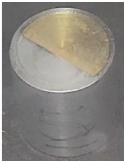
Рис. 1. Выжигание герметика с поверхности образца
