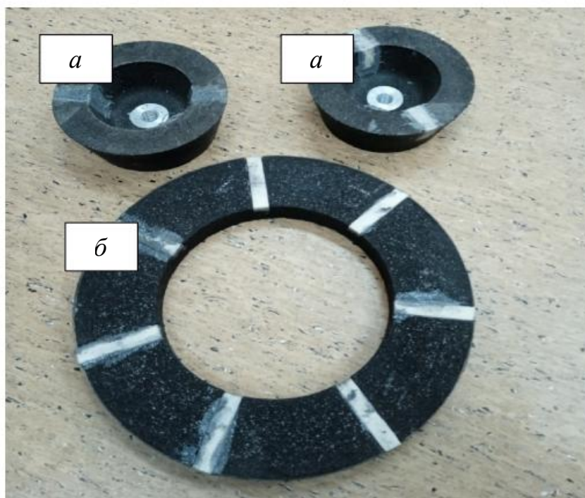
Рис. 2. Экспериментальные образцы композиционных шлифовальных кругов:
