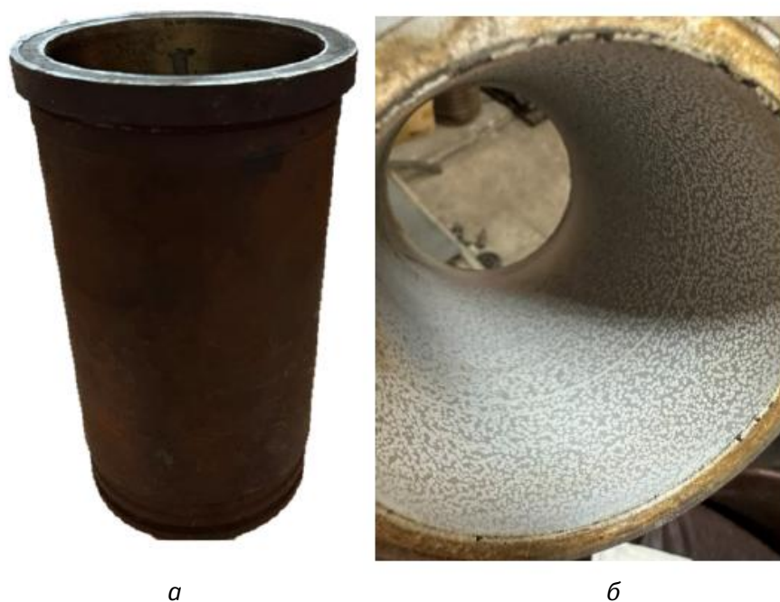
Восстановленная гильза блока цилиндров двигателя GZ-195N: а — общий вид; б — рабочая поверхность
