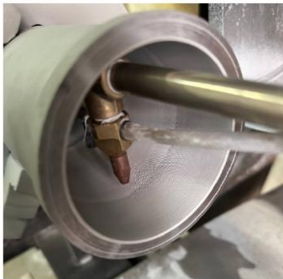
Рис. 3. Напыление гильзы блока цилиндров GZ-195N
