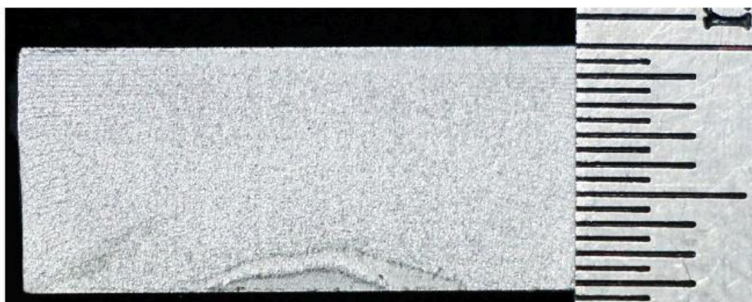
Рис. 5. Боковая кромка реза алюминия толщиной 8 мм (шероховатость поверхности: Ra 5,13 мкм, Rz 32,8 мкм; отклонение от перпендикулярности 0,0245 мм, грат отсутствуют)
