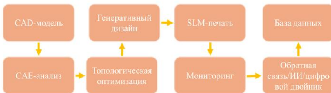
Рис. 1. Роль 3D-модели в цифровом производственном цикле
