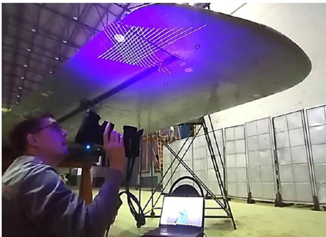
Рис. 1. 3D-сканирование крыла и результаты обработки полученной модели
