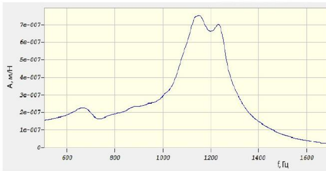
Амплитудно-частотная характеристика шпиндельной группы на кончике фрезы
