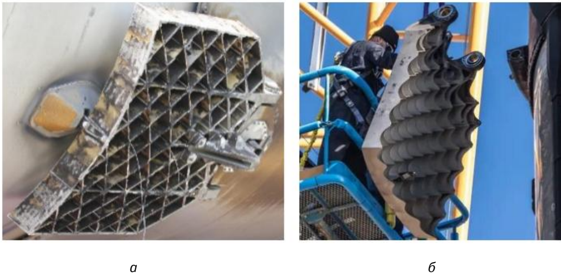
Рис. 3. Решетчатые рули FH Falcon 9: а — ранние конфигурации; б — поздние
