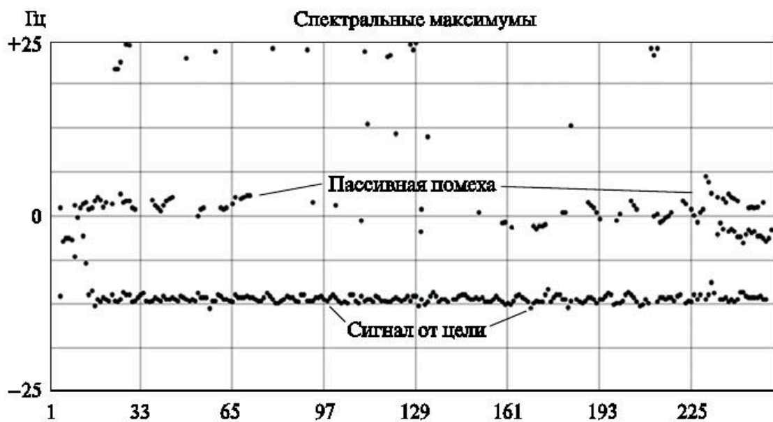
Рис. 9. Оценка динамики изменения доплеровского смещения на 259-м такте обработки на 256 периодах повторения импульса
