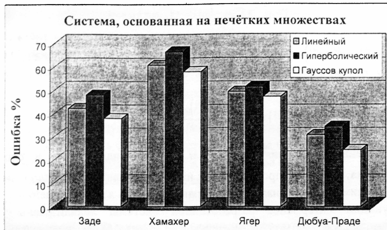
Рис. 1. Зависимость уровня ошибки \varepsilon в процентах от вида контура огибания ВФП и типа теоретико-множественных операций объединения при тестировании на множествах средней сложности.
