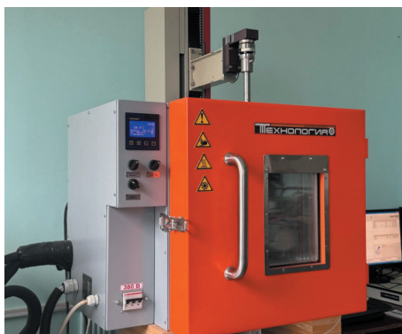
Рис. 1. Испытательная машина Zwick Roell Z2.5 , совмещенная с камерой тепла и холода КТХ-20
