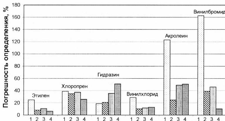
Рис. 4. Относительные погрешности определения концентраций газов в шестикомпонентной смеси этилен - хлоропрен - гидразин - винилхлорид - акролеин - винилбромид
