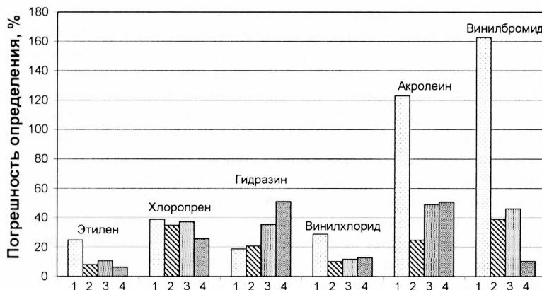
Рис. 4. Относительные погрешности определения концентраций газов в шестикомпонентной смеси этилен - хлоропрен - гидразин - винилхлорид - акролеин - винилбромид
