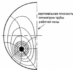
Рис. 4. Вспомогательная расчетная сетка в плоскости, перпендикулярной оси шнека
