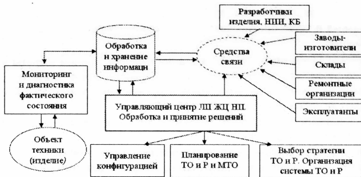
Рис. 1. Логистическая система мониторинга и диагностики состояния объектов техники
