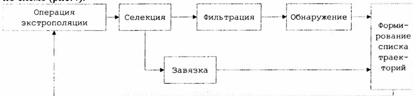
Рис. 4. Структурная схема алгоритма траекторной обработки движения клеток. Параметры траектории определяются по фиксированной выборке.
