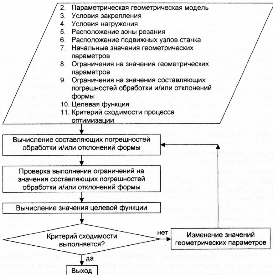
Рис. 3. Блок-схема параметрической оптимизации формы корпусных деталей станков на базе конечноэлементных расчетов их силовых смещений
