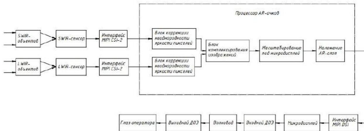
Рис. 4. Функциональная схема инфракрасного двухдиапазонного визира
