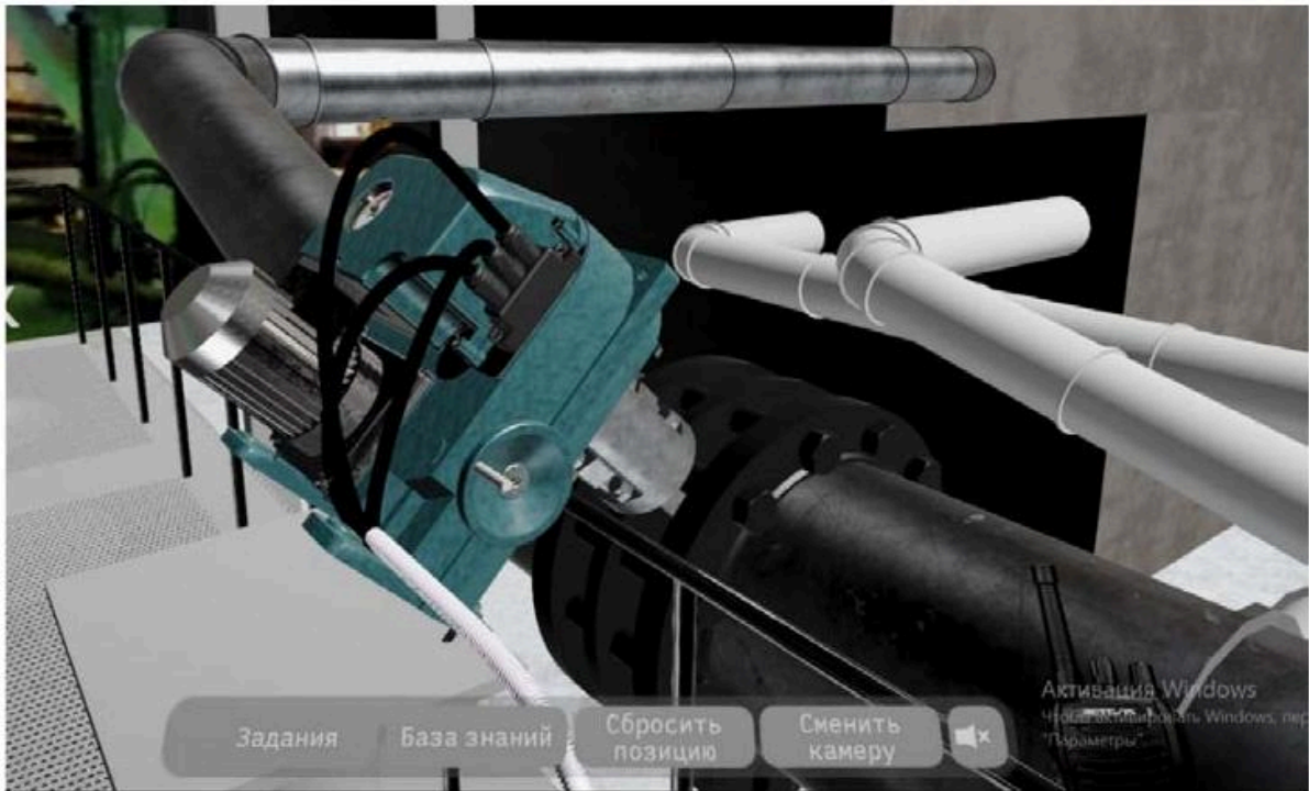
Рис. 3. Пример 3D-модели локации задвижки с электроприводом
