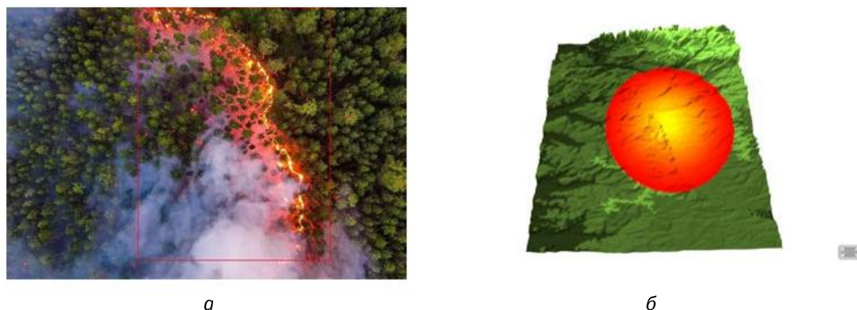
Рис. 2. Результат обработки изображения пожара в Красноярском крае [7]: а — изображение с выделенным участком пожара после обработки алгоритмом детектирования; б — визуализация возгорания в WebVR
