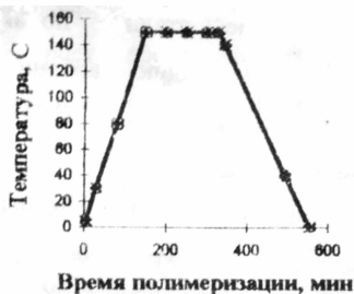
Рис.1. Диаграмма режима полимеризации углепластиковых трубчатых образцов
