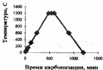
Рис.3. Диаграмма режима карбонизации углепластиковых трубчатых образцов
