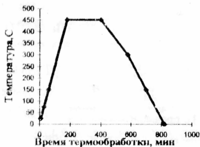
Рис.1. Диаграмма режима полимеризации углепластиковых трубчатых образцов
