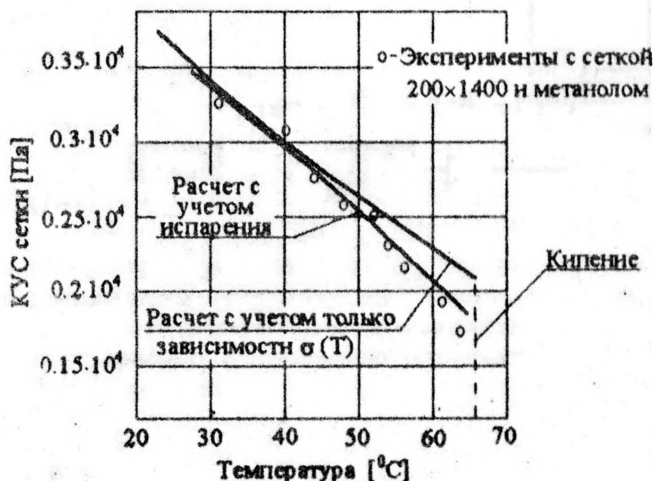
Рис. 16. Влияние температуры сетчатого фазоразделителя на его капиллярную удерживающую способность: o - экспериментальные данные, Paynter H.L., Page R.G..
