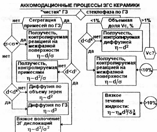
Рис.1. Алгоритм выбора реологического уравнения вязкости, показатель закона вязкости N и структурной чувствительности p в зависимости от структурных и фазовых характеристик керамики: V_c - объемная доля стеклообразующей фазы, ГЗ - граница зерен
