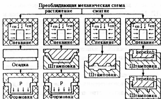
Рис.3. Технологические схемы процессов обработки давлением керамических материалов в состоянии сверхпластичности
