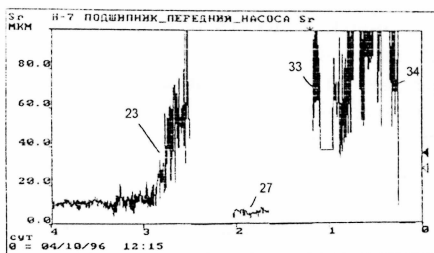
Рис. 7. Быстрые тренды диагностических сигналов: а) виброперемещения при ослаблении крепления насоса НК210; б) температуры подшипника скольжения электродвигателя ВАО500L-2 центробежного насосного агрегата НПС200/700
