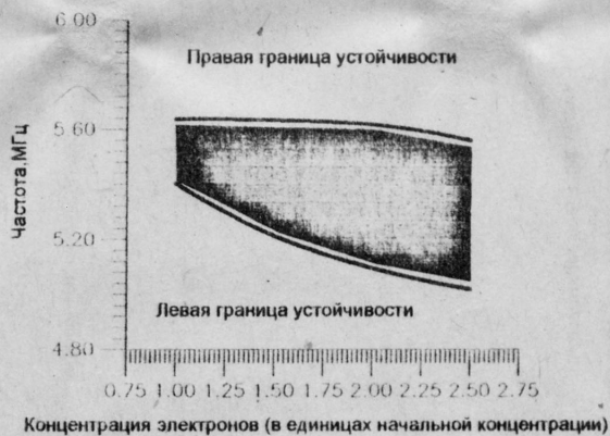
Рис.6. Изменение границ неустойчивого диапазона частот для альфвеновской ионно-циклотронной неустойчивости в установке GAMMA-10.
