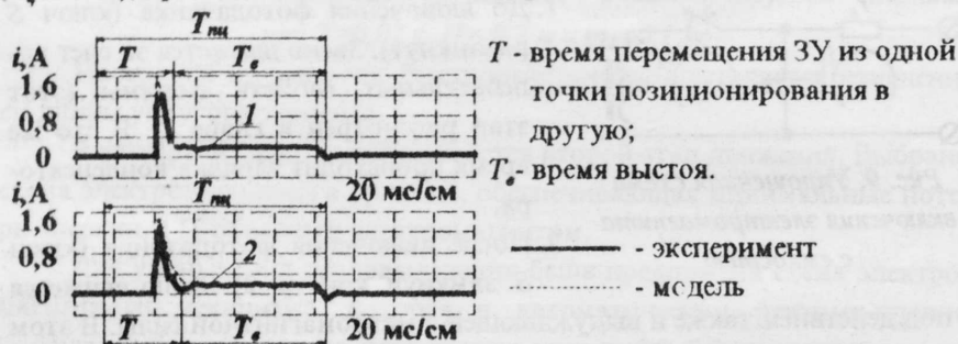
Рис. 11. Сравнение экспериментальных характеристик с результатами расчета при \delta_n=1 \text{ мм} (1) и \delta_n=1,6 \text{ мм} (2)
