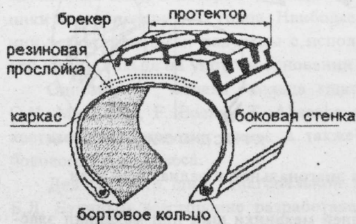
Рис. 1. Основные конструктивные элементы пневматической шины
