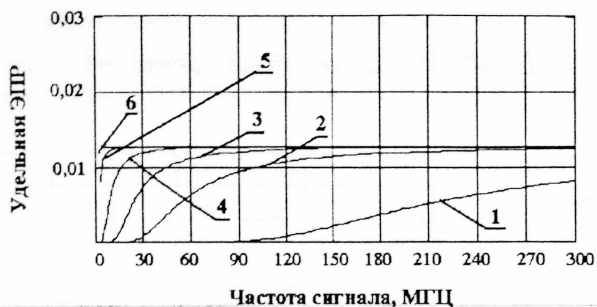
Рис. 6. Удельная ЭПР резонансных отражений первого порядка в метровом и декаметровом диапазоне, рассчитанная по спектральной модели Пирсона-Московитца для различных скоростей ветра: 1 - 1 м/с, 2 - 2 м/с, 3 - 3 м/с, 4 - 5 м/с, 5 - 10 м/с, 6 - 20 м/с
