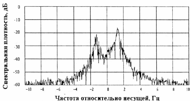
Рис.4. Модель спектра рассеянного на частоте 162 МГц сигнала. Скорость ветра - 4 м/с, угол между направлением ветра и направлением зондирования - 60^\circ , мощность шума -60 дБ
