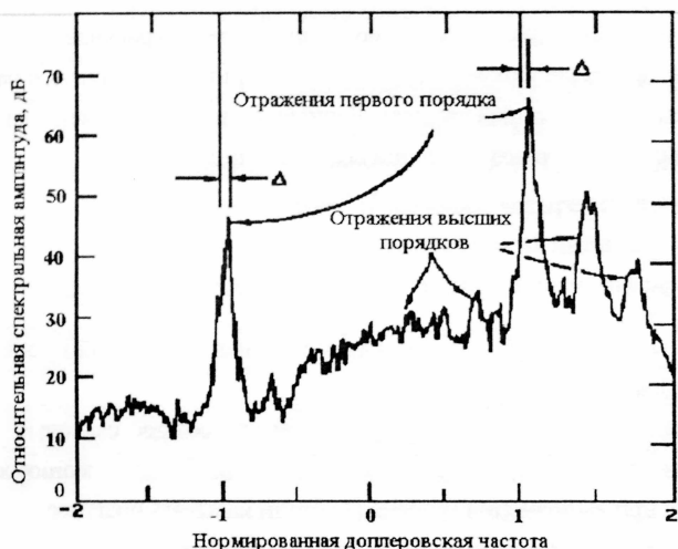
Рис. 1. Усредненный доплеровский спектр радиолокационных отражений от морской поверхности на частоте 9,4 МГц.
