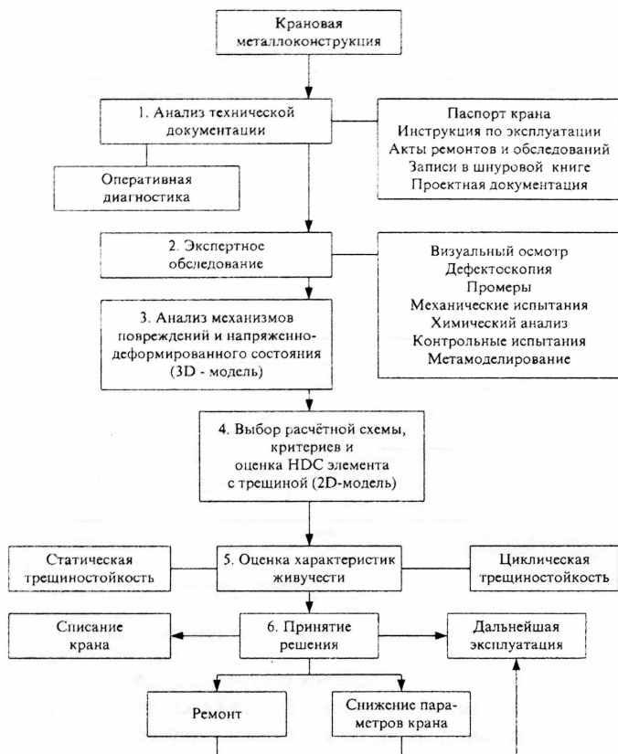
Рис.6. Структурная схема оценки характеристик живучести по критериям механики разрушения
