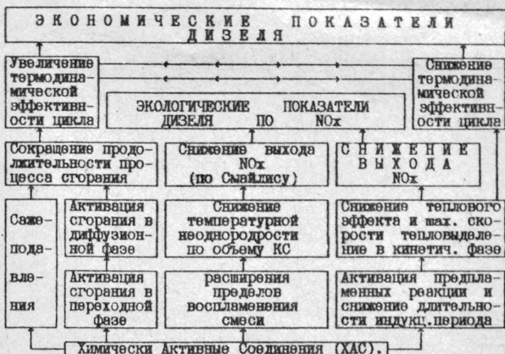
Рис.1 Метод организации рабочего цикла дизеля с улучшенными экономическими и экологическими показателями.
