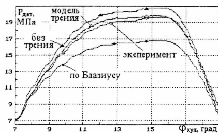
Рис.9. Давление датчика в длинной трубе при различных оценках трения при турбулентном течении
