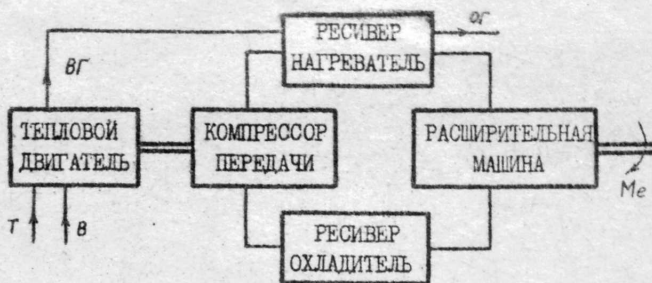
Рис.1 Обобщенная тепловая схема силовых установок с газовой связью.
