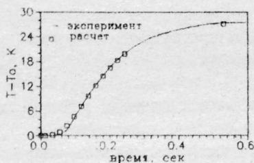
Рис. 3. Значения температуры в центре тыльной поверхности образца
