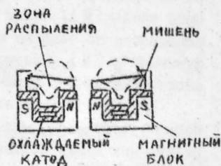
Рис. 10. МРУ с мишенью расположенной в углублении катода.
