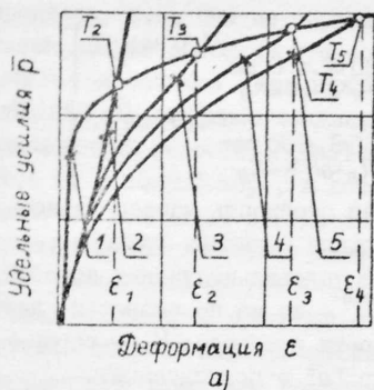
Рис.1. Моделирование силовых параметров процессов ОМД: а - моделирование объекта (кривая 1) с использованием нескольких схем испытаний (2-5); б - аналогия по \bar{p} между скоростными (кривая 1) и статическими (2) процессами
