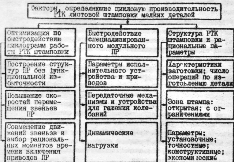
Рис. 1. Принципиальная схема взаимосвязи факторов, определяющих цикловую производительность РТК листовой штамповки мелких деталей
