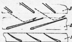
Рис. 5. Решетки лопастей шнека (1), направляющего аппарата (2), центробежного колеса (3) и предполагаемое изменение направления обратных токов после их отражения от лопастей направляющего аппарата при "двухвальном" рабочем процессе насоса.
