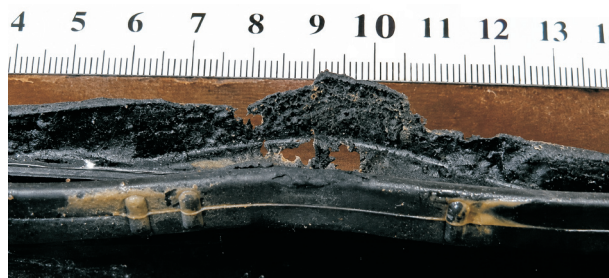
Рис. 1. Внешний вид сквозного локального термического повреждения пластиковой крышки клапанов и двусторонних термических повреждений прокладки
